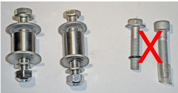
Die mitgelieferten Befestigungsschrauben für den Umlenkhebel und Spannrolle werden ersetzt. Die im Einbausatz enthaltenen Schrauben mit Stopmmuttern und Unterlegscheiben verwenden! **Bitte die genaue Position der großen und kleinen U-Scheiben im Foto beachten!**
