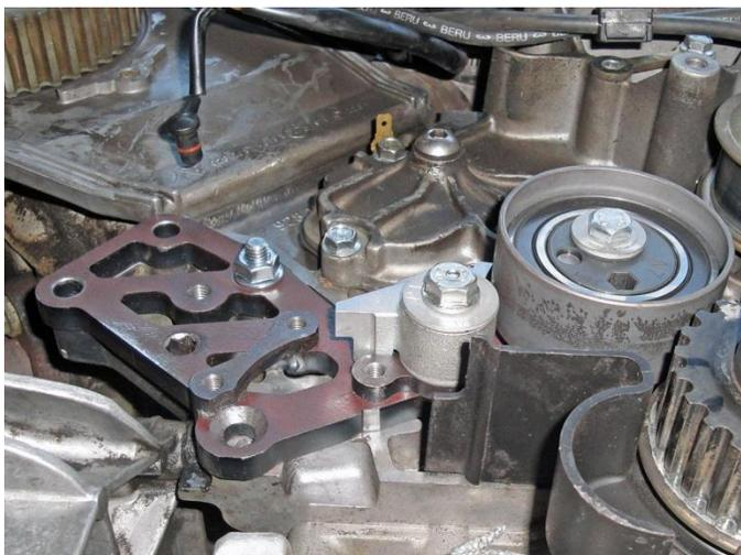
Halteplatte über den M8 Stehbolzen montieren (Mutter nur handfest).
