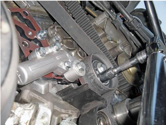
Mit einer 8 mm Inbusstecknuss die Spannrolle im Uhrzeigersinn drehen bis zu einem Drehmoment von 15 NM. Sicherstellen, dass der ZR gleichmäßig straff gespannt ist.
