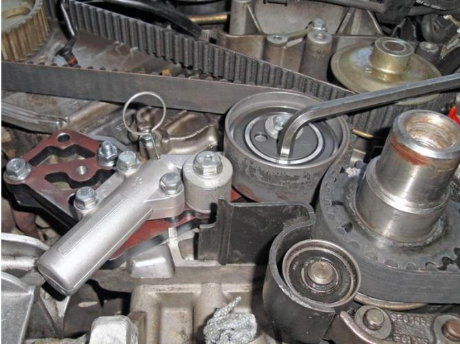
Mit einem 8 mm Inbusschlüssel die Spannrolle gegen den Uhrzeigersinn drehen bis der Sicherungsstift entfernt werden kann.
