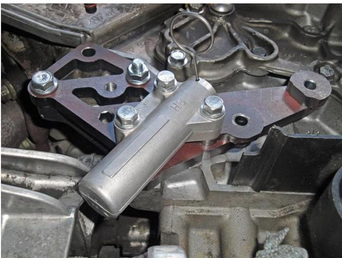
Hydraulischen Aktuator mit M6x30 zur Probe installieren. Jetzt prüfen ob zwischen dem Aktuator und der Halterung für den Klimakompressor ausreichend Platz vorhanden ist. (Ein Stück Papier zwischen die beiden Bauteile stecken). Ist das nicht möglich, dann etwas Material von Klimakompressorhalterung abtragen (DREMEL).
