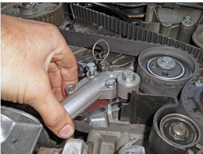
Den Aktuator im Uhrzeigersinn drehen bis alle übrigen M6x30 Schrauben installiert werden können.
