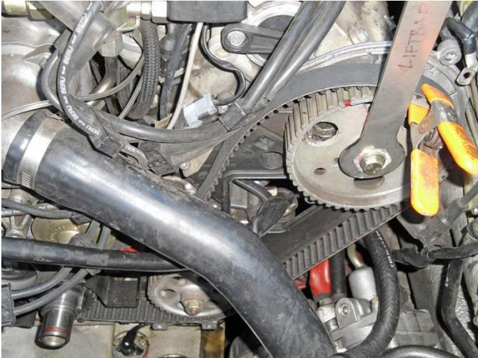
Mit einem geeigneten Schlüssel das Stirnrad (Zyl. 5-8) im Uhrzeigersinn ca. einen Zahn drehen.
