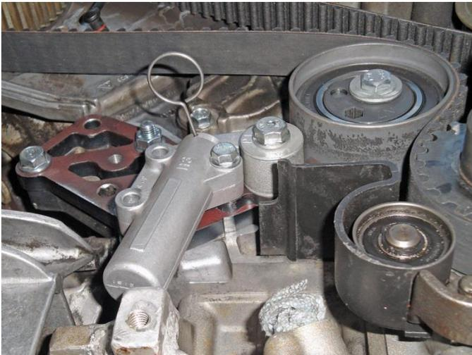
Den hydraulischen Aktuator mit einer M6x30 Schraube locker installieren.
