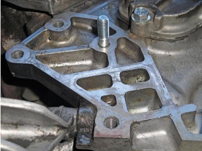
M8x40 Bolzen einschrauben bis zum Anschlag. (Drehmoment dafür ist nicht spezifiziert, etwas mehr als handfest ist ausreichend)
